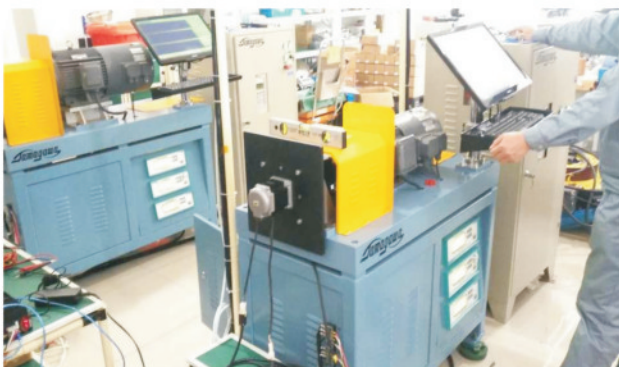
多摩川伺服电机对拖测试台 Tamagawa Servo Motor Drag Test Deslc
